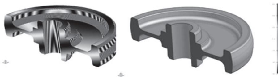
Obrázek 4: Řez 3D CAD modelem s analýzou konzistence ploch metodou odrazu paprsku
